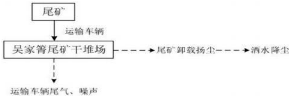
图 2.2-19 尾矿干堆场工艺流程及产污节点图
